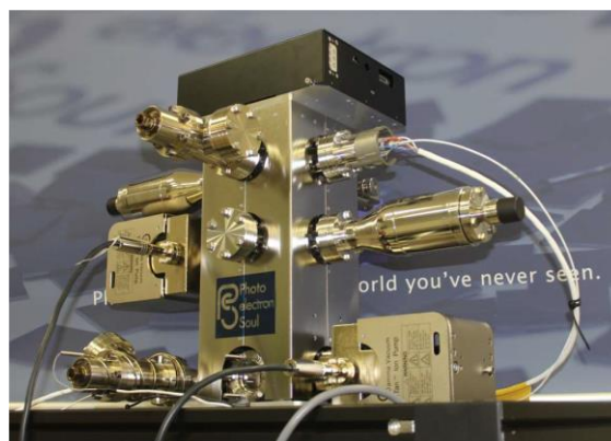
【同社が開発した産業用電子ビーム生成装置】
