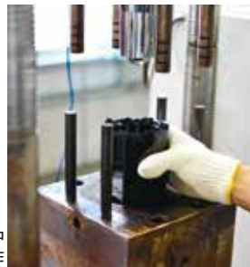
フェノール樹脂材料の成型品 ツールポットを製作
