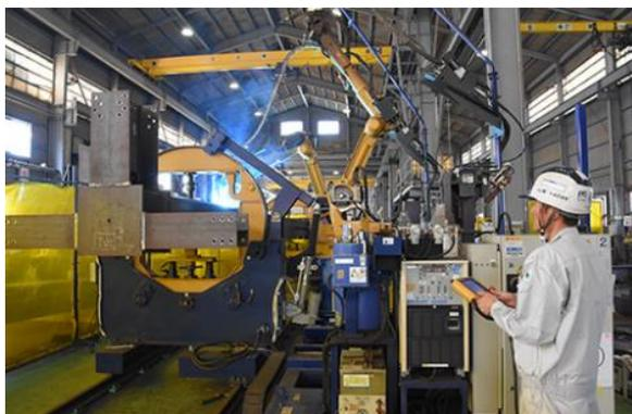
（溶接時に飛び散って固まる粒）が少ない、溶接時間が短い等のメリットを有するNEW・REGARC 溶接機（神戸製鋼所製）を導入し、溶接作業環境の向上と一層の効率化を図っている。
